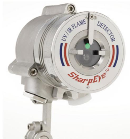
Der Zweikanal-UV/IR-Flammenmelder 40/40-L4B ist mit einer \*BIT-Funktion (Built-in-Test) ausgestattet. Der Melder detektiert Flammen mit Kohlenwasserstoff-Beteiligung, Wasserstoff-Verbindungen, Wasser-Sauerstoff-Verbindungen, sowie Metallen- und anorganischen Verbindungen, im UV-Bereich bei 0,185 bis 0,260  $\mu\text{m}$  und im IR-Bereich bei 4,4 bis 4,6  $\mu\text{m}$ .
