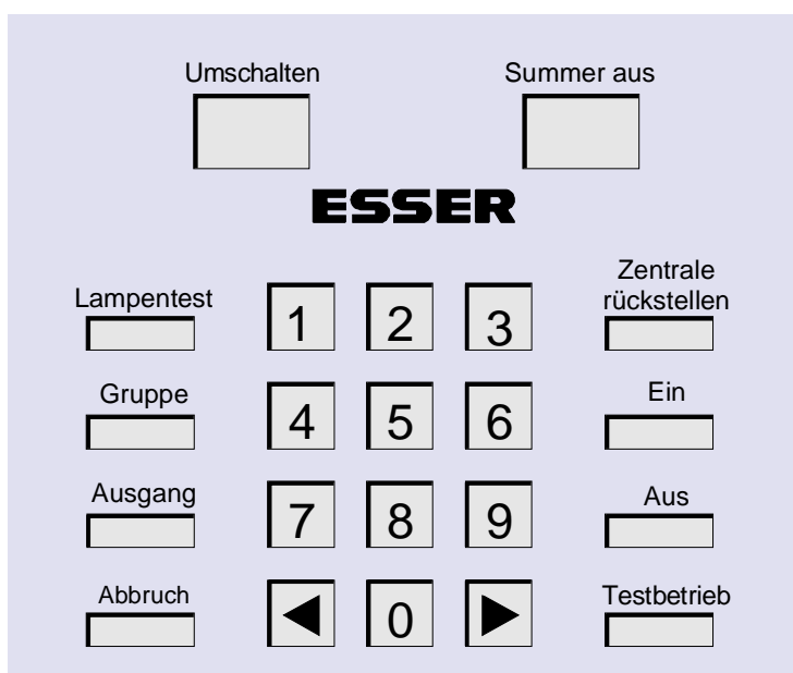
Abb. 6: Bedienfeldtastatur der Löschmittel-Ansteuereinrichtung 8010 - Serie 3
