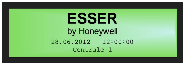
Afb. 18: De brandmeldcentrale in normale toestand
