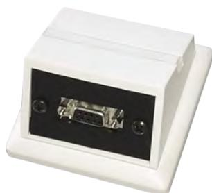
Boîtier à montage encastré pour stations d'appel de table avec prise D-Sub à 9 broches verrouillable et filtre EMI/RFI. Raccordement rapide par bornes à vis. En option, prise de sortie verticale ou inclinée à 30°. Complet avec cadre unique approprié pour la gamme d'interrupteur du système GIRA 55, blanc pur. Montage mural possible avec le boîtier à montage en surface (N° réf. : 581329).
