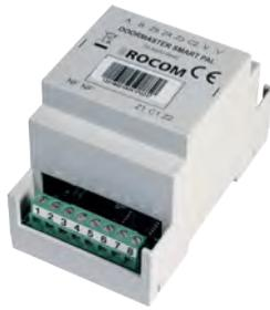
L'interface téléphonique DOORMASTER SMART PAL permet d'enregistrer des annonces via un système de téléphone analogique dans le système d'alarme vocale VARIODYN® D1. Jusqu'à 4 zones ou circuits d'appel différents peuvent être adressés via le système de téléphone. À cette fin, des contacts de commande 1 + 4 sont disponibles pour la mise sous tension et/ou la sélection de zone.
