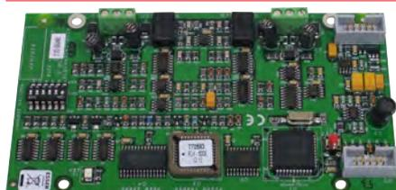
Les cartes bus pour le Centralisateur de Mise en Sécurité Incendie adressable CMSI 8000 assurent la gestion de voies de transmission rebouclées pouvant gérer 128 lignes de télécommande. A l'initialisation, le CMSI 8000 identifie automatiquement par une reconnaissance de ligne le câblage des voies de transmission, détermine l'adresse logique de chaque matériel déporté et localise une éventuelle erreur de câblage ou court-circuit.
