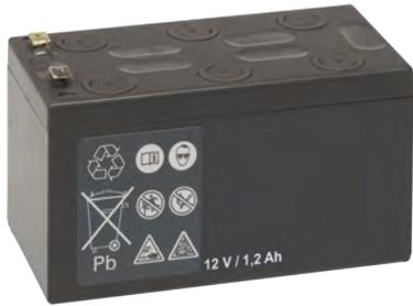
Ces batteries au plomb étanches avec électrolyte solide sont sans entretien. Ces batteries de stockage de 12 V ont une tension de charge de 13.8 V (6 x 2.3 V par élément) à une température d'utilisation de 20 °C.
