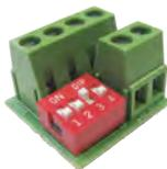
Kit de câblage destiné au raccordement des positions d'attente et de sécurité des DAS raccordés aux MD2L et MD4L. Un élément est nécessaire pour la position d'attente et un pour la position de sécurité sur chaque DAS. Chaque élément peut être paramétré soit en mode collectif soit en mode individuel à l'aide des switches..
