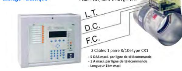
Ce document est une simple aide à la mise en application des produits de la gamme ESSER. Ce synoptique ne peut en aucun cas être considéré comme un schéma de réalisation ni se substituer à la réglementation en vigueur. La nature des câbles est donnée de manière indicative, se référer à la norme NF S 61-932
