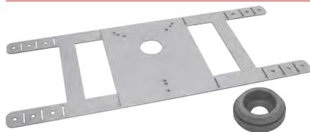
Kit de montage pour boîtier 781443, à utiliser sur les gaines rondes et isolées. Dans ce cas, le trou de montage du tube du côté de montage du boîtier 781453 devra avoir un diamètre de 50 mm. L'étanchéité est assurée par un joint en caoutchouc.
