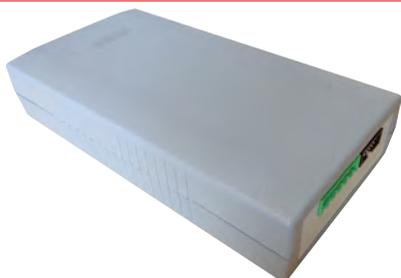
Le Control Line permet d'effectuer une reconnaissance de câblage sur un bus CMSI8000. Une fois la reconnaissance terminée l'outil permet d'afficher un synoptique du bus avec les adresses physiques, ainsi que les numéros de série des matériels déportés présents. En cas de dérangement sur le bus il est possible d'effectuer un test de défaut terre permettant ainsi de localiser de ce défaut.
