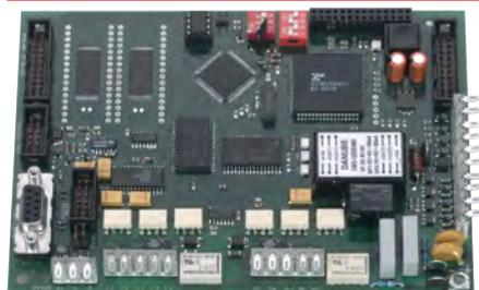
La carte IGIS Loop permet d'effectuer la mise en réseau du CMSI8000 (32 CMSI max.). La distance entre 2 utilisateurs est de maximum 1200 m.
