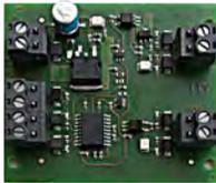
Ce convertisseur permet la communication entre l'ECS FlexES Control et les CMSI de la gamme ESSER by Honeywell. De plus il assure une isolation galvanique entre les 2 tableaux.
