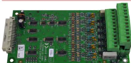
Les cartes 12 boucles assurent la gestion des liaisons filaires entre un Système de Détection Incendie conventionnel et le CMSI 8000 ou la gestion des lignes de Déclencheurs Manuels et le CMSI 8000 (en type B). Les cartes 12 boucles gèrent 12 zones de détection.
