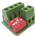
Kit de raccordement pour les lignes de contrôle de position de DAS. Il peut être utilisé soit pour la position d'attente soit pour la position de sécurité des DAS. Chaque kit dispose d'un dipswitch autorisant une utilisation soit en mode collectif soit en mode individuel (3 adresses possible par ligne).
