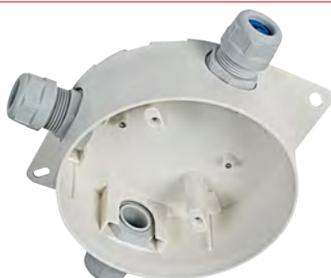
L'embase pour locaux humides IP 43 est adaptée au montage avec tubes et possède 3 entrées pré-découpées pour presse étoupe M20. L'embase est livrée avec 3 presses étoupes autorisant un montage avec sortie supplémentaire pour indicateur d'action. Elle est adaptée au montage avec les détecteurs IQ8Quad et ES Detect.
