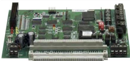
L'interface série pour raccordement au réseau essernet® peut être utilisée pour relier WINMAGplus au système de détection incendie. L'unité comprend un emplacement pour un module essernet® permettant une connexion réseau.
