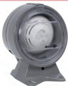
Boîtier pour détecteur de gaine équipé des tubes venturi 781446, 781447 ou 781448 en combinaison avec un détecteur optique de fumée. Le tube Venturi s'installe à l'intérieur de la gaine. Le détecteur une fois monté est accessible en retirant le couvercle plastique transparent. Durant le fonctionnement, le voyant d'alarme du détecteur est visible.
