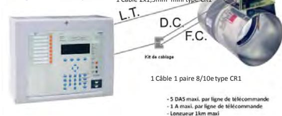
**SOLUTION 3 : Raccordement de DAS câblage « classique »**
