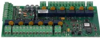
Les coupleurs 12 relais permettent de piloter un Centralisateur de Mise en Sécurité Incendie (CMSI) conventionnel.
